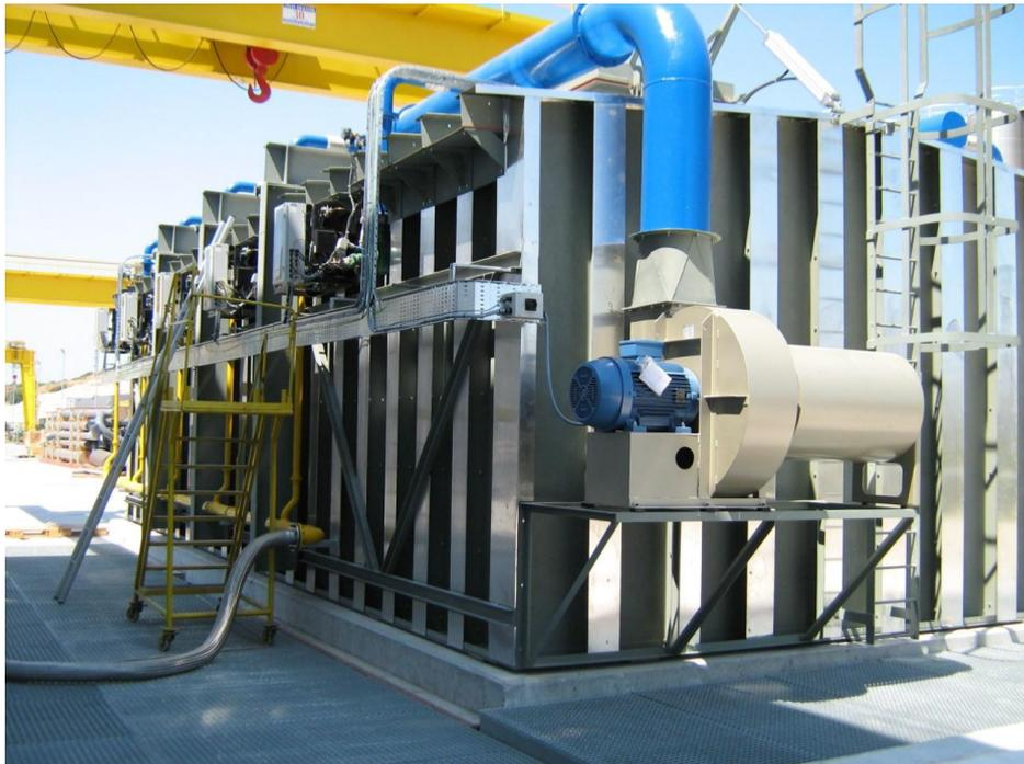
*Four à gaz 9 MW – 1150 °C pour le recuit de tubes , détente et normalisation*
