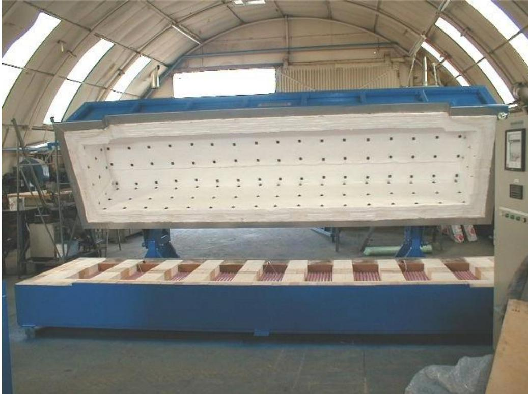
*Four électrique 110 KW -1000°C 7mx1mx0,6m avec couvercle rabattable par charnières.
