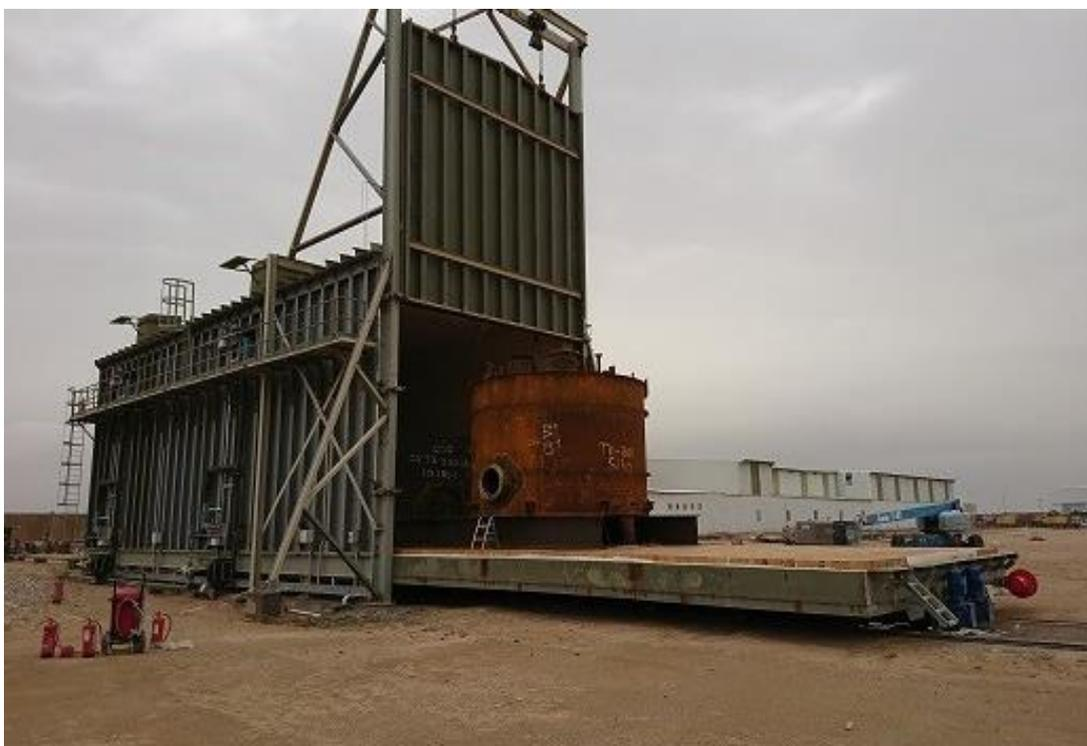
*Four 1.7 MW – 700°C – 13mx3mx3m avec porte guillotine . Chargement frontal via chariot roulant
