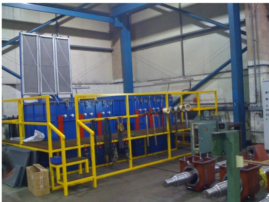
*Four électrique 350 KW – 260°C compartimenté pour le préchauffage des roues de train*
