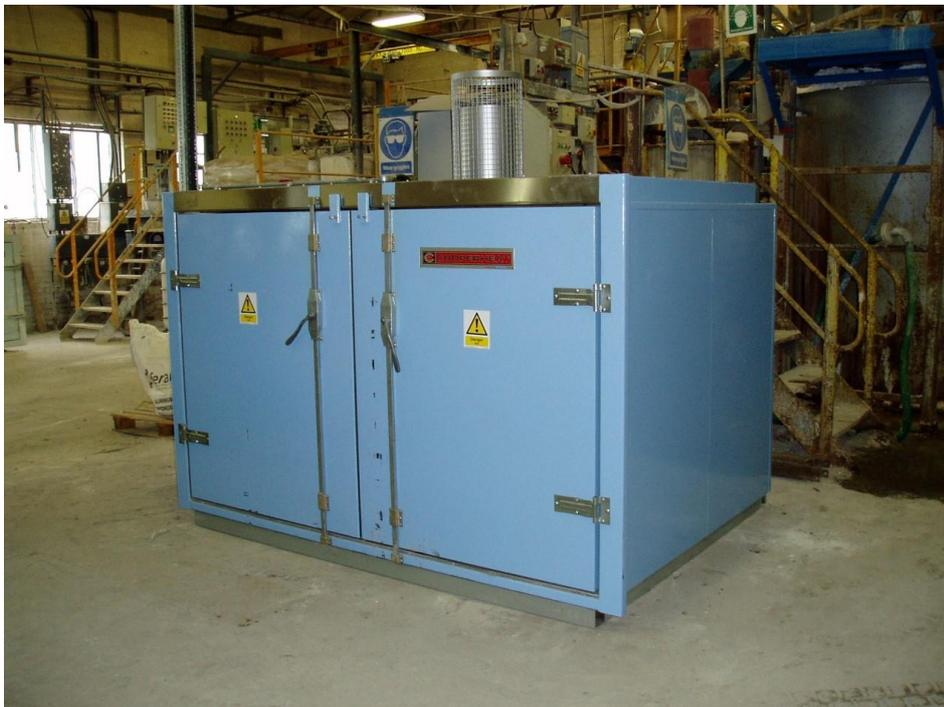
*Four électrique pour la calcination 70 KW – 500°C . Modèle à double porte*
