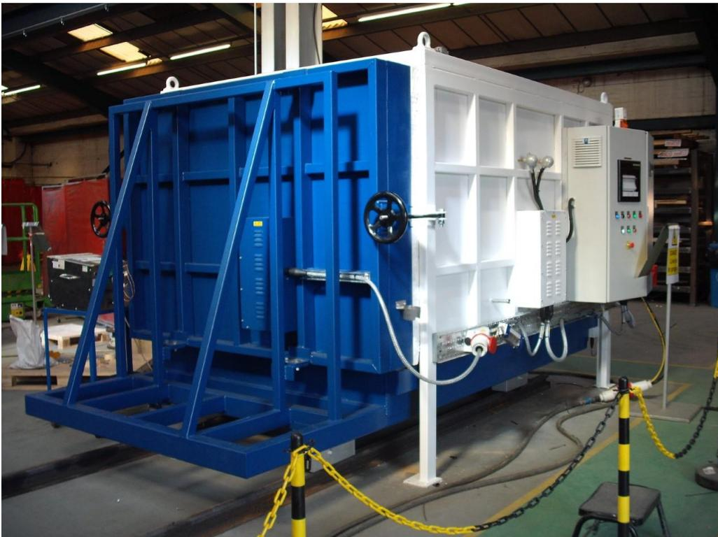
*Four électrique mobile 67 KW – 1000°C pour le traitement / durcissement des mâchoires de frein*
