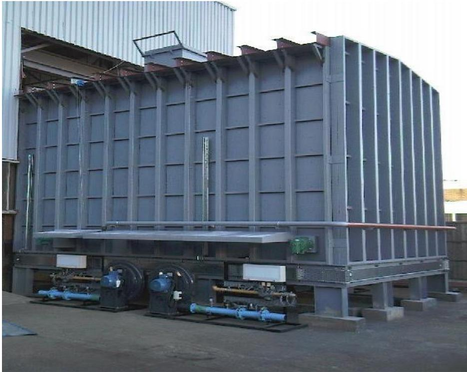
*Four gaz 3.5MW – 800°C - 8,5mx4,8mx4m avec chargement latéral
