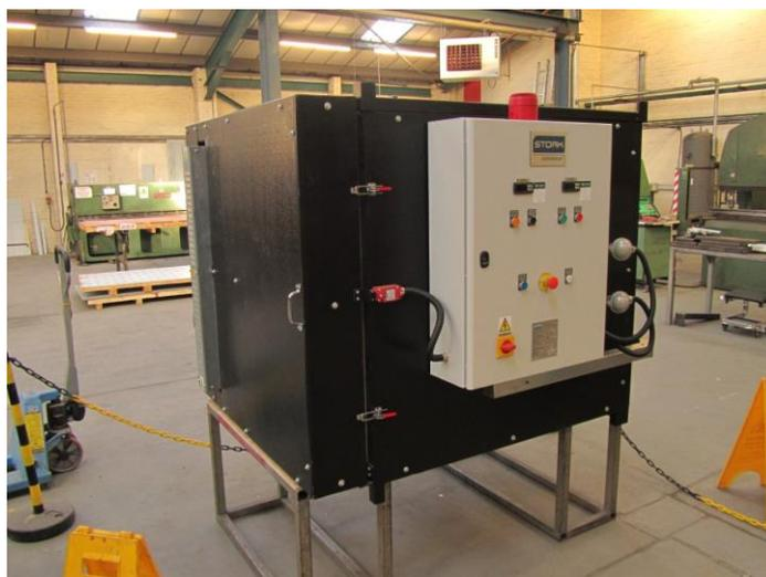
*Four électrique 18 KW – 600°C pour le durcissement*
